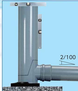
マス天端を水平に、立上り部を垂直になるように据付結合すると、所定の管路勾配で配管できます。
