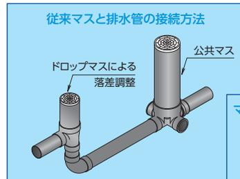
ホールソー受口による落下調整によりマスの設置数を削減できます。
