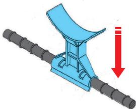
**2** コンクリート打設時の管の浮上防止として上から固定する方向へ取付けます。
