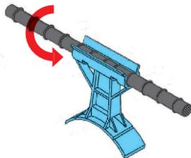
**3** マルチスリーブホルダーと鉄筋を結束線等で確実に固定し、その後付属の樹脂製結束バンドを利用して管を固定します。
