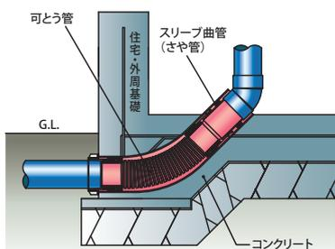
構造躯体に影響を及ぼすことなく、専用配管の点検、および補修が可能です。
