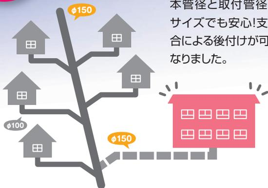
本管径と取付管径が同サイズでも安心!支管接合による後付けが可能となりました。
