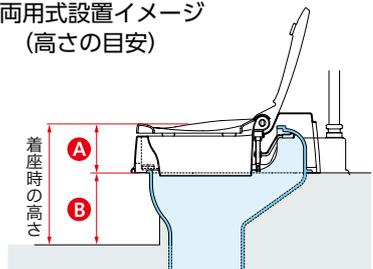
製品の便座までの高さ：(A寸法) + 床の段差 (B寸法) が実際の着座時の高さになります。
