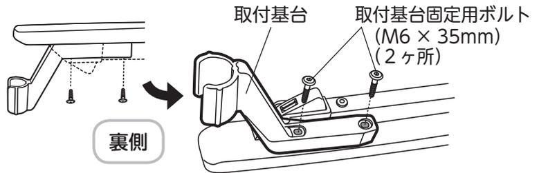
② 取付基台へ中間軸部、「2. ペーパーホルダーを組み立てます」で組み立てたペーパーホルダー部を取り付けます。
