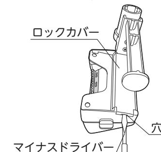
■本体固定用ネジを外してからロックカバーを外してください。
