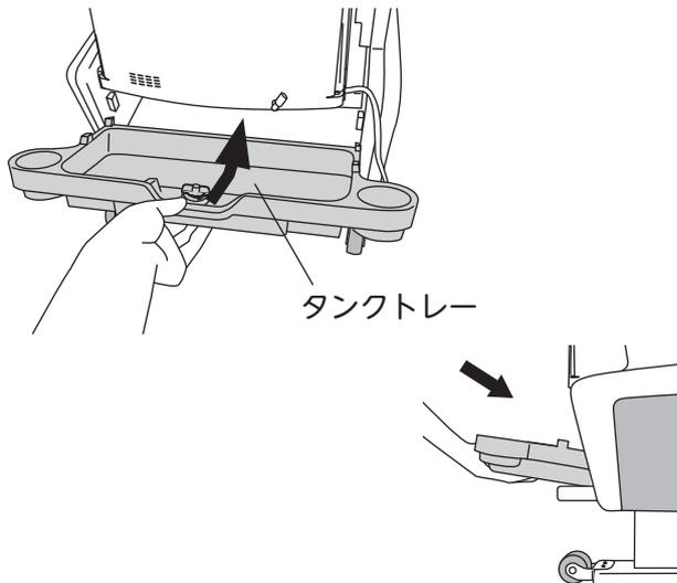
②給水タンクをタンクトレーにのせて、スライドさせ収納し、タンクトレー固定レバーをまわし固定します。
