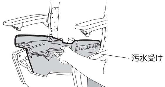
④お手入れが終わったら逆の手順で、汚水受け、スライド受け板、バケツ、温水洗浄便座、折れ座面を設置します。
