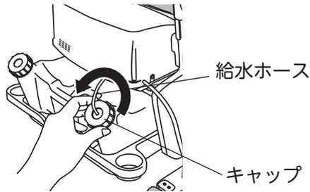
② 給水ホース先端のゴミ取りフィルターを外し、キャップを交換します。
