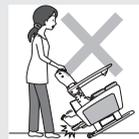
※段差などでキャスターが使えず製品を持ち上げる場合は、図のようにひじ掛けの付け根を持ち上げてください。
