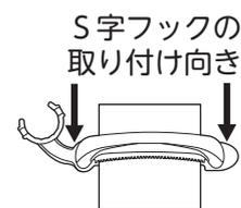
②下敷きをベッド柵にテープで貼り付けてから横フレームに S 字フックをかけて、縦フレームにホルダー軸の取り付け部を引っ掛けてセットします。
