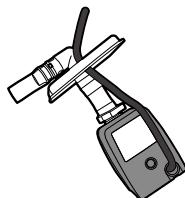
洗浄水ポンプ
