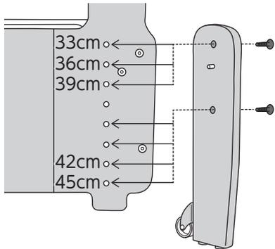
低い高さに設定するときは、補高脚の上側の穴を基準にする、
