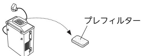
※脱臭器の取り付けは、取り外しかたと逆の手順でおこなっていただき、P.21「脱臭器を取り付ける」に従って、正しく取り付けることができたか確認してください。
