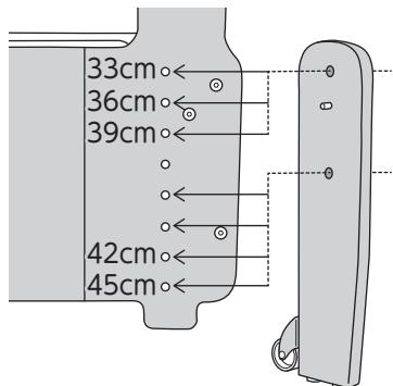
低い高さに設定するときは、補高脚の上側の穴を基準にする、
