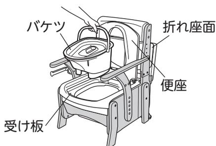
②便座を降ろして、受け板の前を少し持ち上げながら手前にスライドさせ、受け板の後ろを「止めブロック」から抜き、受け板（便座とのセット）を外します。
