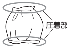
OK：圧着部が平行 NG：圧着部の片方が斜め
