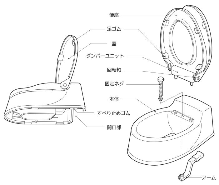
固定ネジを回してアームで和式便器のキンカクシ部分を挟み、仮固定することができます (和式便器への固定のしかたについて詳しくは "取り付け方法 "の①をご覧ください)
