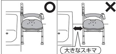
浴槽への移乗に使用する場合、シャワーベンチはできるだけ浴槽の縁と座面の高さを合わせ、浴槽へ接するように横付けしてください。
