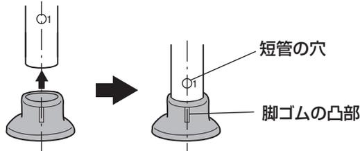
② 脚ゴムは、各位置によって形状が異なります。脚ゴムの底面に記載されている文字を確認して、右図の位置・方向に取り付けてください。
