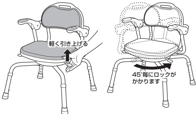
②回転の途中でロック解除レバーから手を放すと、 $45^{\circ}$  の位置で再びロックがかかります。
