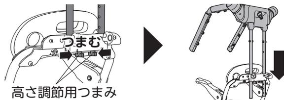
3. 温浴ユニットの高さを調整し、高さ調節用つまみをはなしてパイプの穴にカチッと入るのを確認します
