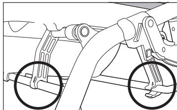
高さ調節用のプッシュボタンが完全に飛び出して固定されていることを確認すること
