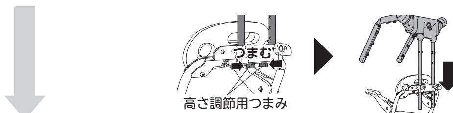
3. 温浴ユニットの高さを調整し、高さ調節用つまみをはなしてパイプの穴にカチッと入るのを確認します
