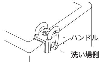
7 浴槽壁のできる限り端に図のようにセットし、ハンドルを右に回して取り付けます。
