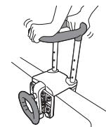
ガタついたりズレ動いたりした場合は、製品を取り外し、P.13 を参照しながら浴槽へ再度取り付け、しっかりと固定してください。※取り付け面のヌメリは拭き取ってください。
