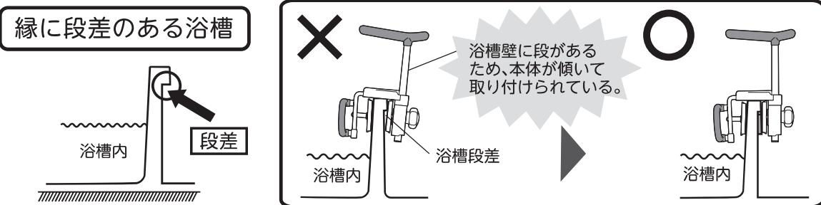
浴槽の縁に段差がある場合は、段差の大きさに合わせた補正方法に従って、補正をしてください。
