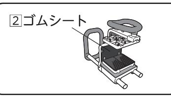
① 押圧ゴム板が外れた場合は、P.19 「押圧ゴム板の交換方法」を参考にしてはめ直してください。
