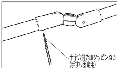
③付属の十字穴付き皿タッピンねじ（手すり固定用）で手すり
