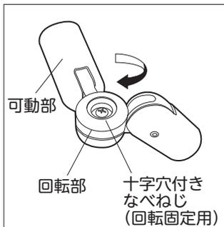
②回転部を回転させ手すりの方向を決め、十字穴付きなべねじ
