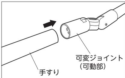
①手すりを可変ジョイント（可動部）に差し込みます。
