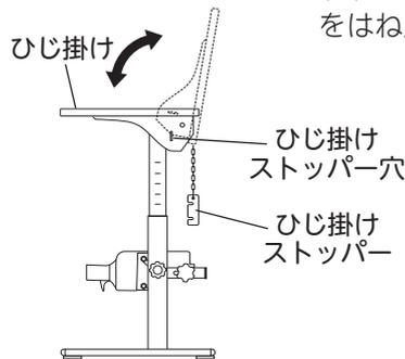
※ひじ掛けをはね上げない場合は、ひじ掛けストッパーをひじ掛けストッパー穴に差し込み、ひじ掛けをはね上げないこともできます。
