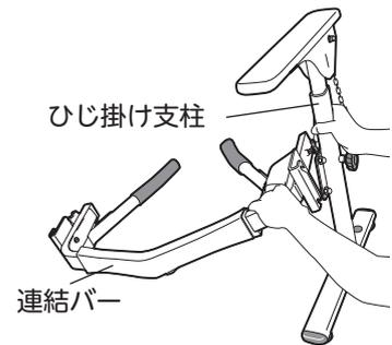
②右図のように、連結バーの切り欠き部分に、ひじ掛け支柱のネジ切り部分をスライドしてはめてください。
