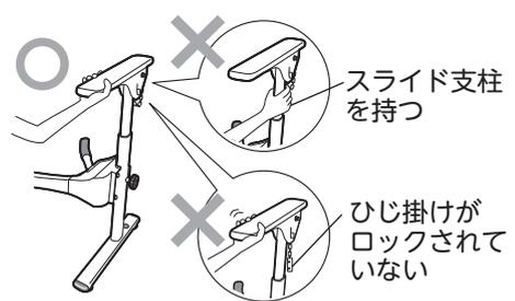
高さ調節ボルトがしっかり締め付けられ、ひじ掛けにガタつきがないか確認すること
