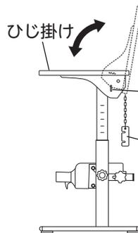
※ひじ掛けをはね上げない場合は、ひじ掛けストッパーをひじ掛けストッパー穴に差し込み、ひじ掛けをはね上げないこともできます。
