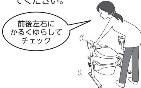
② 便器から製品が動くようなら、P.11「便器への取り付け方法」を確認し、再度取り付けてください。
