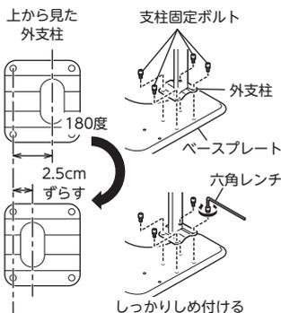
外支柱を 180 度回転させることで取付穴位置に対して支柱の位置をずらす仕組みです。
