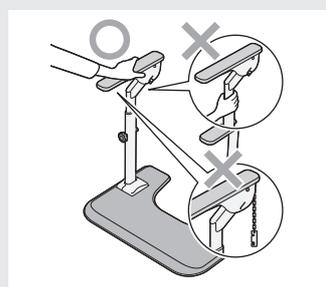
高さ調節ノブボルトは、工具を使用してしめ付けないこと
