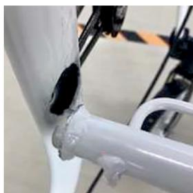
傾斜地に製品を止めて着座したことによる破断
