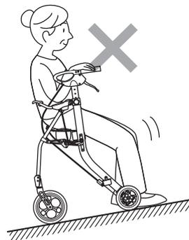
着座時に偏荷重をかけたことによる破断
