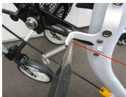
リンク軸 前方のフック 折りたたみバネ
