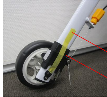
テープで仮固定 ブレーキプレート
