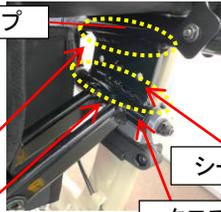
シートパイプ固定板とシートパイプ、シートパイプ固定板とクロスバー連結パイプの溶接確認
