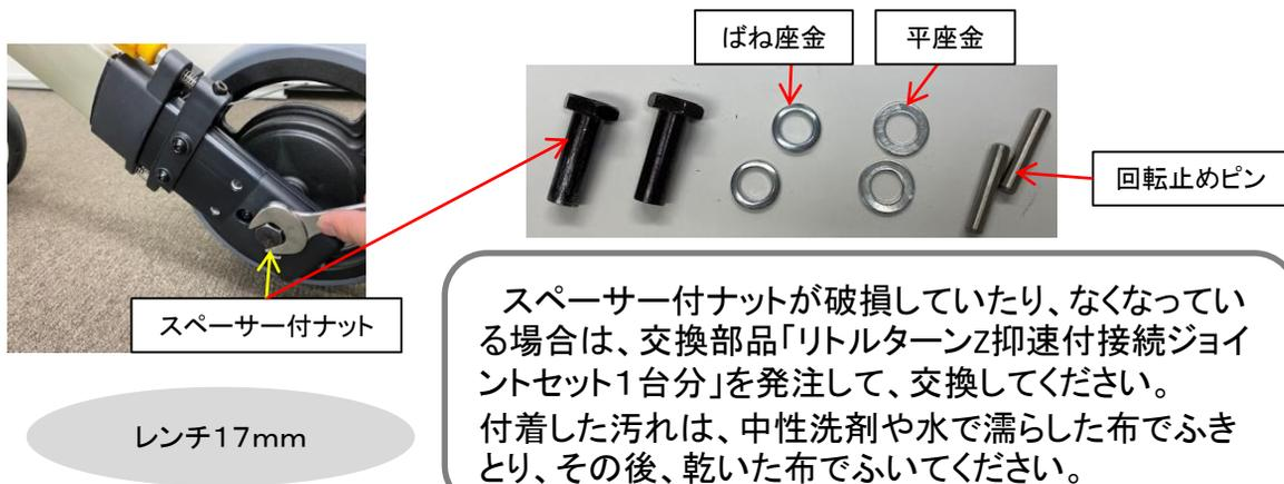
スペーサー付ナットが破損していたり、なくなっている場合は、交換部品「リトルターンZ抑速付接続ジョイントセット1台分」を発注して、交換してください。
