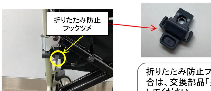
折りたたみ防止フックツメに傷、割れ、摩耗、紛失がある場合は、交換部品「折りたたみ防止フックツメ」を発注し、交換してください。
