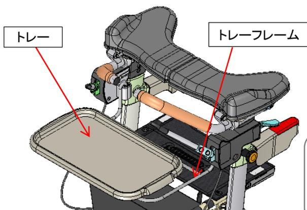
トレー・トレーフレームに異常がある場合は交換部品「トレーセット」を発注し、交換してください。
