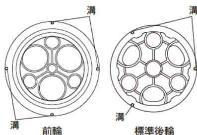
前輪、後輪に摩耗や割れがある場合は、交換部品「前輪セット(2個入り)」「後輪セット(2用)」を発注して、交換してください。
