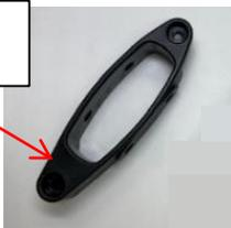
ブレーキブラケットに傷、割れ、紛失がある場合は、交換部品「ブレーキブラケット(2個入り)」を発注し、交換してください。
