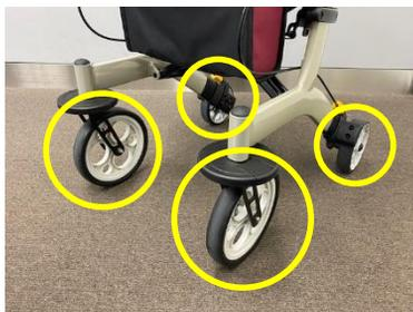
前後4輪が同時に接地しない場合は、タイヤの摩耗状態を再度確認してください。
