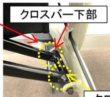
クロスバー連結パイプとクロスバー下部の溶接確認
