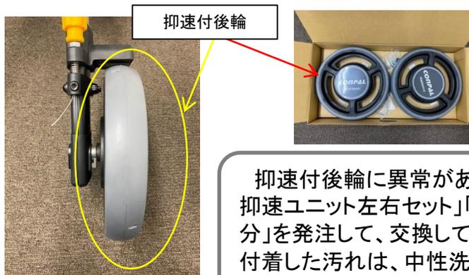
抑速付後輪に異常がある場合は交換部品「LT II 抑速プラス 抑速ユニット左右セット」「LT II 抑速プラス交換タイヤキット1台分」を発注して、交換してください。
