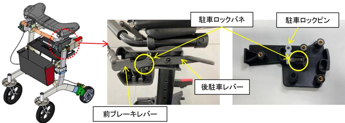
駐車ロックに異常がある場合は、交換部品「駐車ロックピンセット」を発注し、交換してください。
