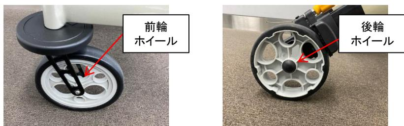
前輪ホイール、後輪ホイールに傷、割れ、紛失がある場合は、交換部品「前輪セット(2個入り)」「後輪セット(2用)」を発注し、交換してください。
