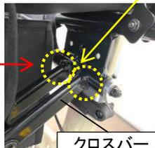
クロスバー連結パイプとクロスバー上部の溶接確認
