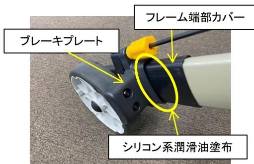
ブレーキプレートの動きが悪い時は、泥や汚れを拭き取ってからブレーキプレートが可動する箇所隙間に少量の「シリコン系潤滑油」を注油してください。
