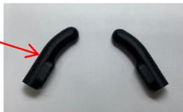
前ブレーキレバー端部カバーに傷、割れ、紛失がある場合は、交換部品「前ブレーキレバー端部カバー左右セット」を発注し、交換してください。
