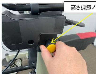
高さ調節ノブボルトが破損していたり、なくなっている場合は、交換部品「高さ調節ノブボルト」を発注し、交換してください。
