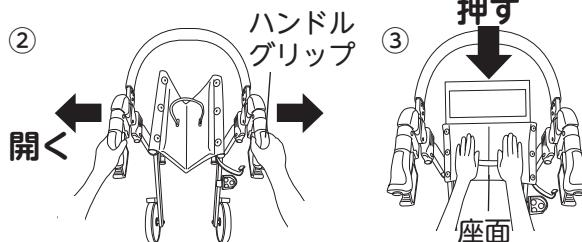
③座面の両端を、右図のように上から手で押し下げます。
