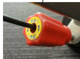
5) ブレーキ調節表示シール ※左側の同じ位置にもあります。
