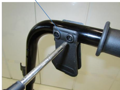
ブレーキ基部固定ボルト
