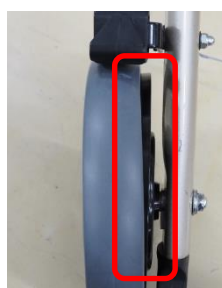
タイヤ側面とホイール側面に 段差がある。
