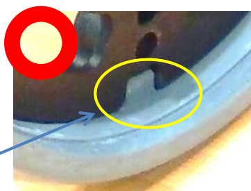
タイヤの向きが正しいと 突起がホイール(内側)に 完全にはまりこむ
