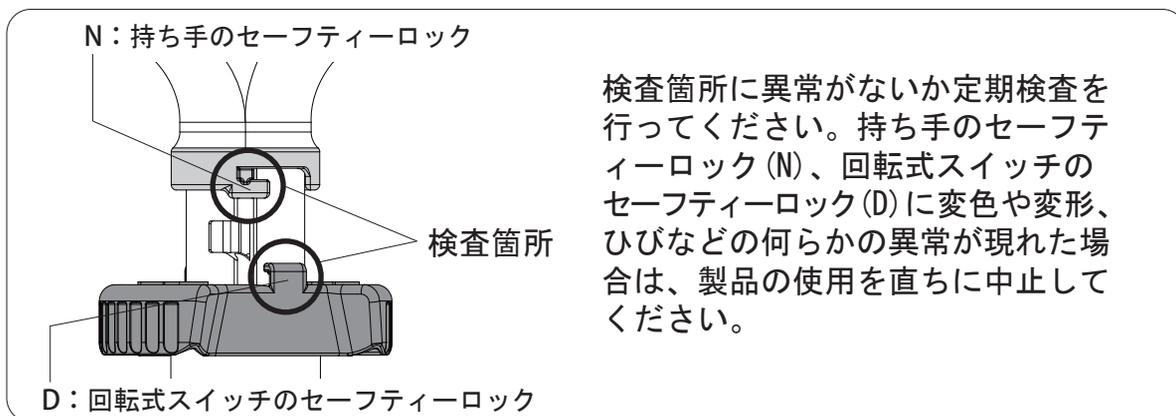
検査箇所に異常がないか定期検査を行ってください。持ち手のセーフティーロック(N)、回転式スイッチのセーフティーロック(D)に変色や変形、ひびなどの何らかの異常が現れた場合は、製品の使用を直ちに中止してください。
