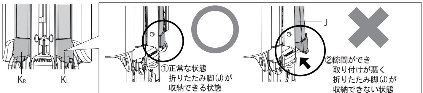
※滑り止め付きゴム脚 (K<sub>L</sub>/K<sub>R</sub>) の取り付け方向の間違いや、あるいは折りたたみ脚(J)が奥まで届いていない場合、収納時に上図②のように隙間ができ、折りたたみ脚(J)の収納ができなくなるため、①のように正常に折りたたみ脚(J)が収納できる状態となるように確認してください。
