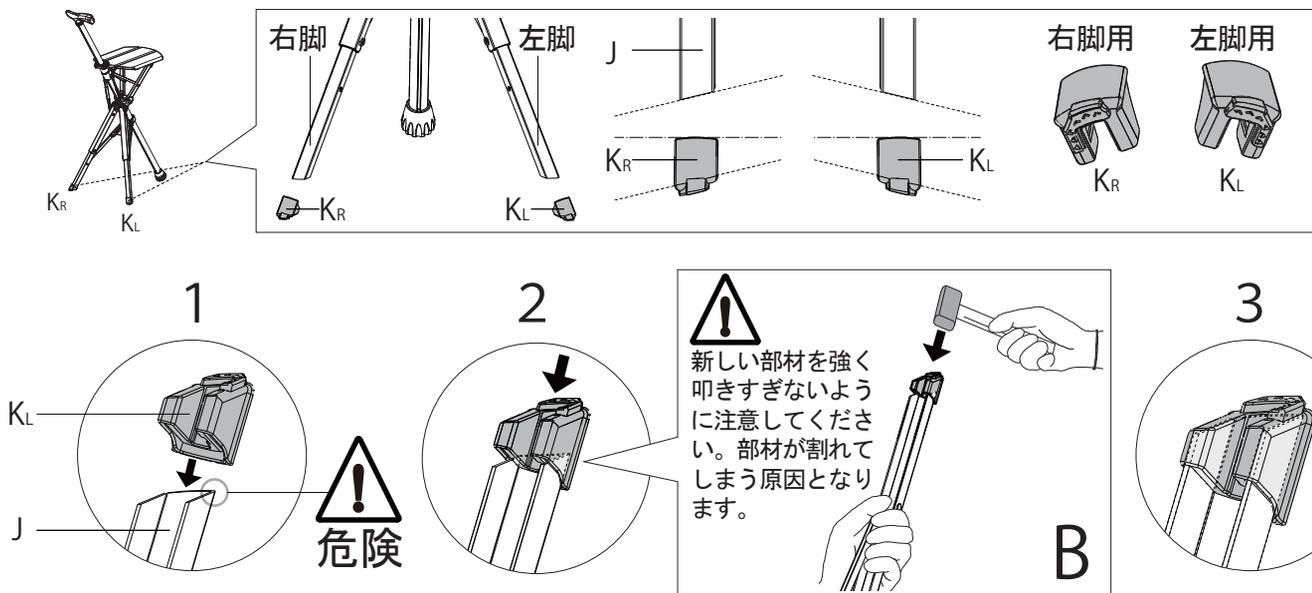
※滑り止め付きゴム脚 (K<sub>L</sub>/K<sub>R</sub>) の取り付けの向きに注意し、取り付け作業時は1のように鋭利な箇所がありますので必ず、作業用手袋等の保護具を着用し作業を行って下さい。滑り止め付きゴム脚 (K<sub>L</sub>/K<sub>R</sub>) を折りたたみ脚(J)に2のように途中まで取り付け、金槌で上図(B)の方向に2、3回軽く叩いて3のように奥まで取り付けてください。
