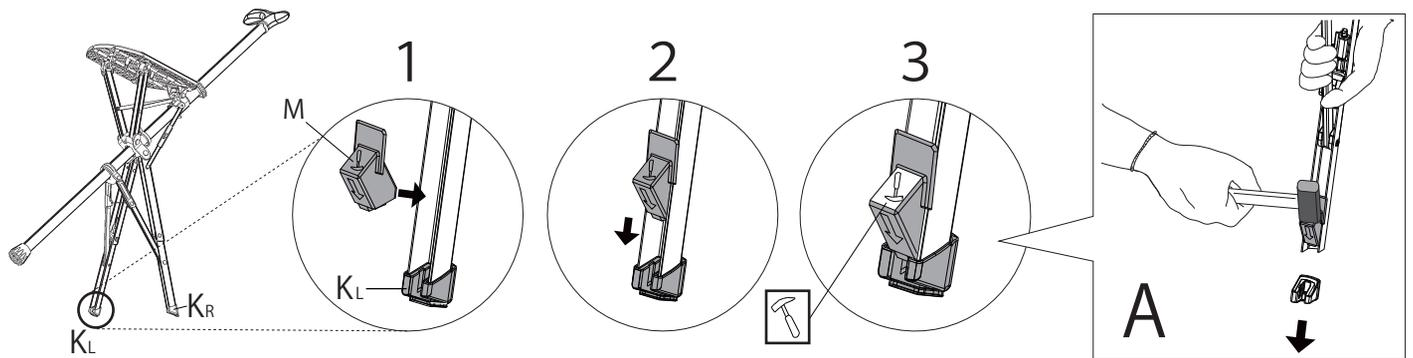
滑り止め付きゴム脚取り外し用具 (M) を1、2の手順で取り付け、3の金槌マーク (🔨) を上図(A)のように下向きに叩いて取り外してください。
