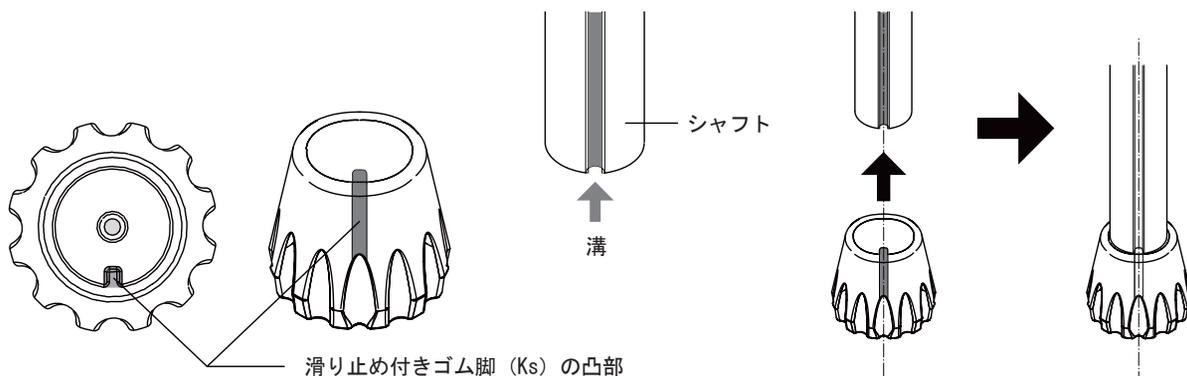
シャフトの溝と滑り止め付きゴム脚 (K<sub>S</sub>) の凸部を一直線上に合わせ、滑り止め付きゴム脚 (K<sub>S</sub>) を差し込んでください。取り付け後は、平らな場所で新しい滑り止め付きゴム脚 (K<sub>S</sub>) 強く押しつけた後、地面を軽く叩くようにし、シャフトがしっかりと部材の奥まで取り付けられているか確認してください。
