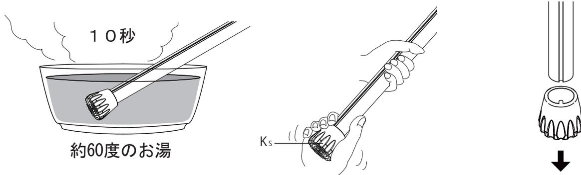
約60度のお湯に10秒つけた後、滑り止め付きゴム脚 (K<sub>S</sub>) を左右に力を入れながら取り外してしてください。(※火傷には十分にお気をつけてください)
