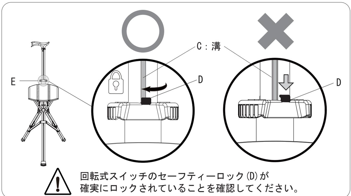
回転式スイッチのセーフティーロック(D)が確実にロックされていることを確認してください。
