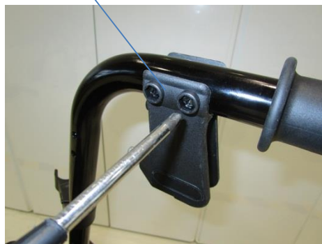
ブレーキ基部固定ボルト
