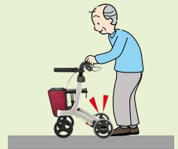
急加速時に抑速ブレーキが作動して転倒を予防します。
