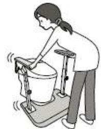
ガタつきやズレがある場合には、再度、高さ調節ノブボルトと支柱固定ボルトを締めなおしてください。それでも改善しない場合は使用を中止して廃棄してください。
