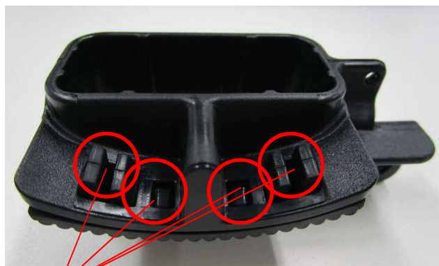
ブレーキパッドの突起 が飛び出している
