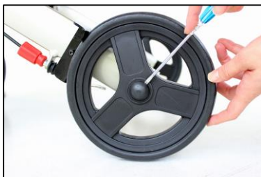
後輪キャップを外します。
