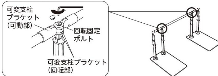
2. 可変支柱ブラケット部の赤枠部分にクラックや打痕傷など製品形状とは異なる異常が無いか確認してください。
