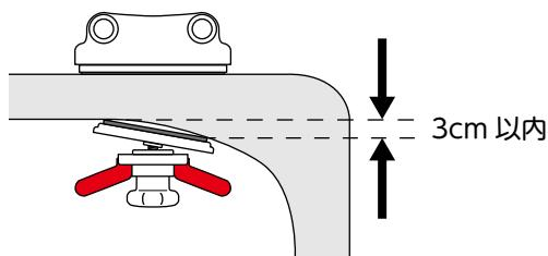
※コーナー部など、押圧ゴム板の接触する面が湾曲している場合、
