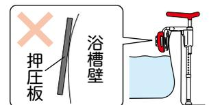
押圧板と浴槽壁の間にすき間が生じるため、製品が抜ける原因になります。
