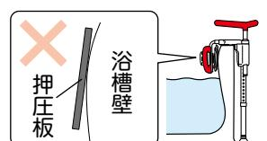
押圧板と浴槽壁の間にすき間が生じるため、製品が抜ける原因になります。
