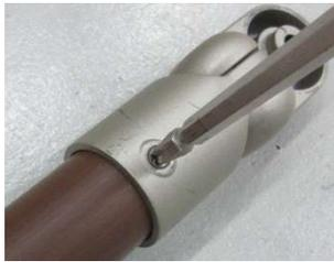
1. 支柱からブラケットがついた状態の丸棒を外し、可変支柱ブラケット部分のねじを両側とも外して、丸棒の端部からブラケットを外します。
