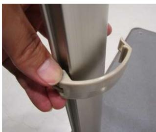
1. 交換する部分の支柱とその隣の支柱の2箇所に使われている高さ調節固定ピンを外します。
