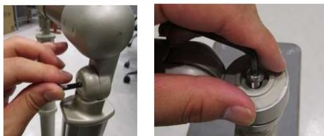
1. 補修したいブラケットになるようにエンド支柱ブラケットと可変支柱ブラケット部分の六角ボルトを六角レンチを回して外します。
