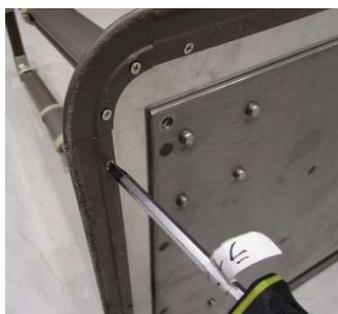
1. ベースプレートを裏返しにして、交換する箇所の皿ボルトをプラスドライバーで回して外してください。
