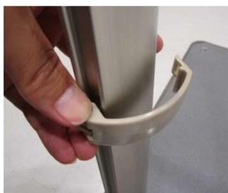
1. 交換する部分の外支柱とその隣の外支柱の2箇所に使われている高さ調節固定ピンを外します。
