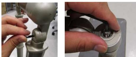
1. エンド支柱ブラケットと可変支柱ブラケット部分の六角ボルトを六角レンチを回して外します。
