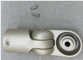
2. 交換するための新しいブラケットと、新しいねじ2本を準備し、ブラケットに丸棒を差し込みます。このときに既に空いている丸棒のねじ穴と同じねじ穴を使用しないように、丸棒を回転させてください。
