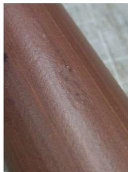
※屋外に設置後、補色部分が変色・ひび割れなどが発生しましたら、ご利用を中止し部材交換をお願いいたします。
