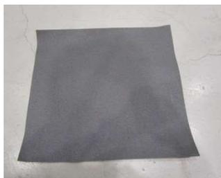
2. 新しい滑り止めシートの裏面にある剥離紙を剥がしてからベースプレートに貼り付けてください。
