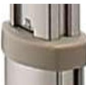
※支柱キャップと支柱プレートカバーは、樹脂なので、屋外に設置していますと、劣化します。設置環境によりますが、2年程度で色が白色になり、日当たりが良い場所ではひび割れする可能性があります。
