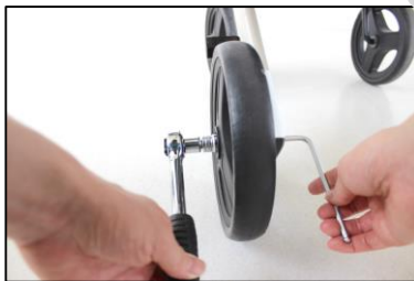
後輪固定ナットを緩め、後輪を取り外します。
