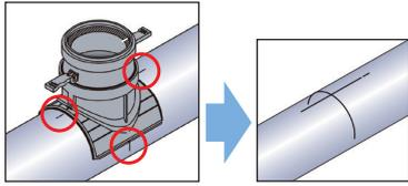
1 仮置きして、スカートのアイマーク位置部 (4箇所) にマジックで印を入れ、上図のように管軸方向と周方向に結びます。
