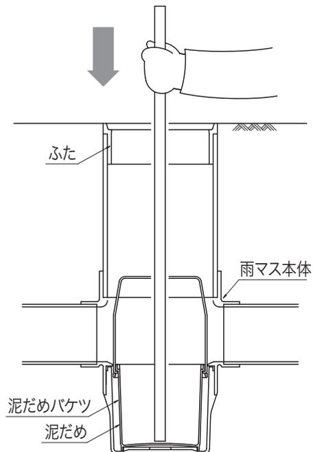
**!** 泥だめバケツが管底より飛び出た状態になっていると、雨水流入時に泥だめバケツが浮き上がり、流れをせき止めてしまうことがありますので注意して下さい。
