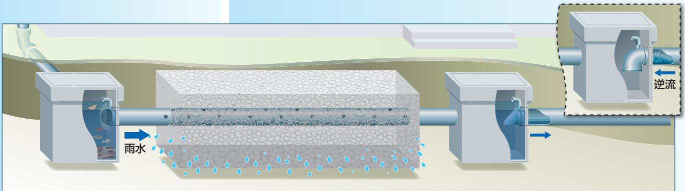
**Point 2** 管内径接続だから後付け設置も簡単に!
